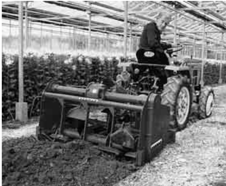
Fig. 2.2 Een spitmachine maakt een prachtig plantbed.
