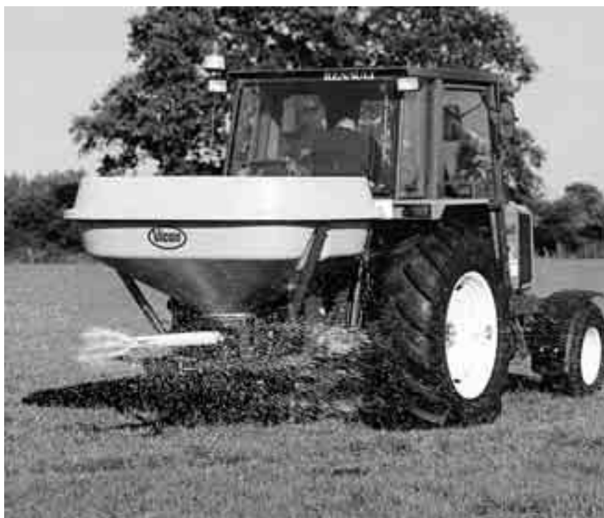
Fig. 3.5 Een kunstmeststrooier zorgt voor een goede verdeling van de kunstmest.
